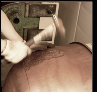
コパーケトルにさらなる剛性を持たせ、ケトルの振動を放射状に響かせ、独特の深みとダークなサウンドを描き出す、パールが誇る入念なハンマリング加工工程。一打、一打が全てハンドメイドの逸品です。
