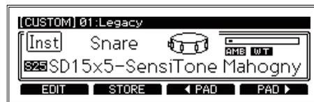
Verwenden Sie den Wahlschalter, um das dem Pad zugewiesene Instrument zu ändern. Sie können die zu bearbeitenden Pads über die Funktionstasten oder durch Anschlagen der Pads selbst auswählen.
