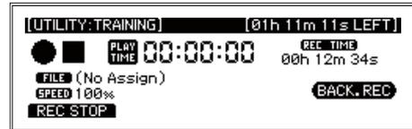
Tip: Sie können maximal eine Stunde am Stück aufnehmen (in einer einzigen Datei), bevor die Aufzeichnung automatisch beendet wird.
